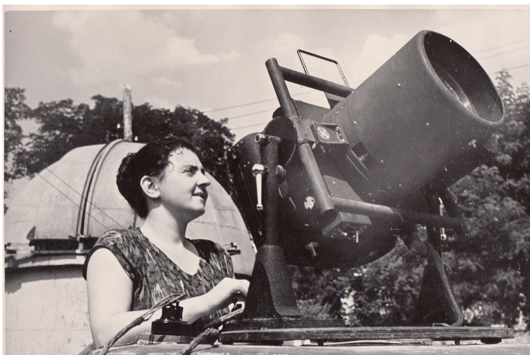
Фото 5. Камера НАФА під час фотографічних спостережень штучних супутників Землі в Астрономічній обсерваторії Київського державного університету імені Тараса Шевченка (зображення з Архіву музею Астрономічної обсерваторії)
